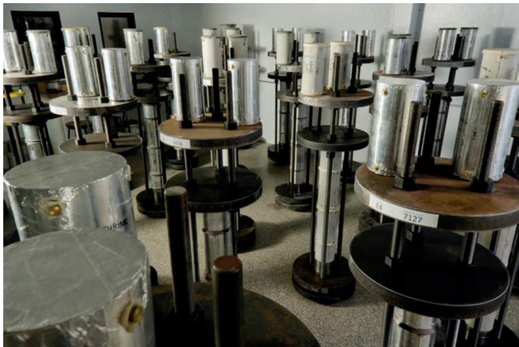
Рис. 5. Лабораторные испытания на ползучесть бетона в соответствии с западными стандартами
