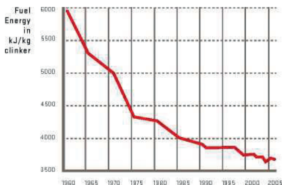
Рис. 7. Снижение расхода топлива при производстве цементного клинкера, КДж/кг
