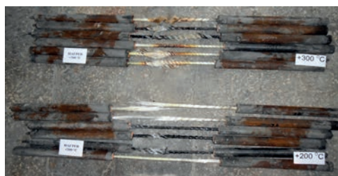
Рис. 6. Характер разрушения образцов АСК при различных температурах нагрева
