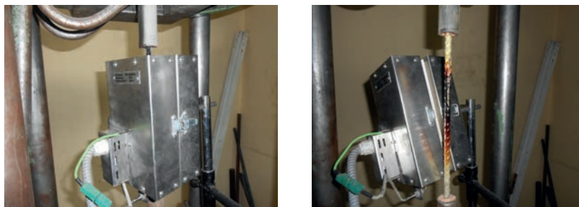
Рис. 3. Характерный вид образцов АСК при испытаниях на нагрев и растяжение: слева – образец в процессе нагрева, справа – образец после охлаждения
