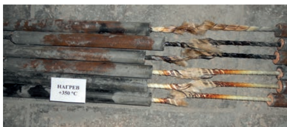
Рис. 6. Характер разрушения образцов АСК при различных температурах нагрева
