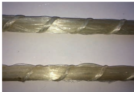
Рис. 2. Дефекты внешнего вида образцов АСК серии 3
