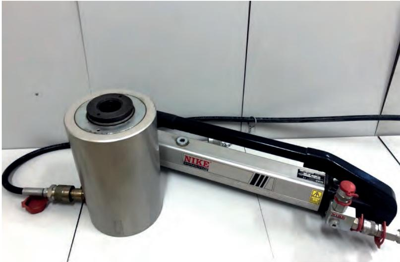
Рис. 1. Прибор HydraJaws для проведения испытаний анкеров на вырыв
