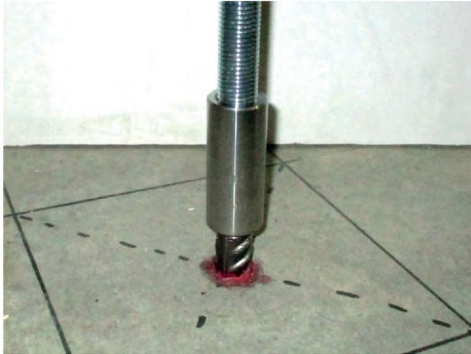
**Рис. 2.** Муфта-захват для арматуры периодического профиля в качестве захвата при испытаниях химических анкеров на вырыв
