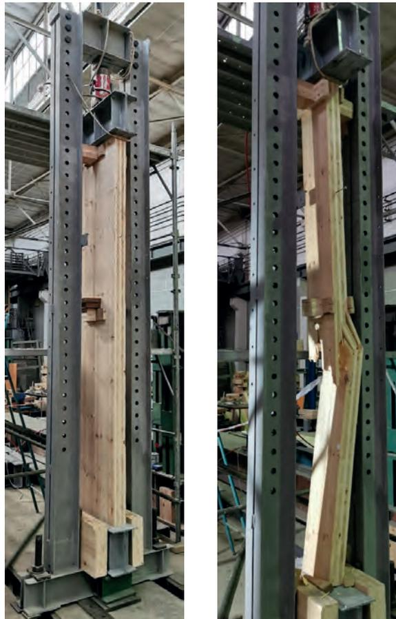
Рис. 2. Испытание 5-слойной панели ДПК (CLT) на устойчивость при сжатии
