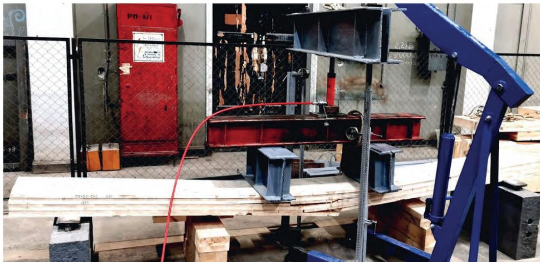
Рис. 3. Испытание 7-слойной плиты ДПК (CLT) на изгиб из плоскости
