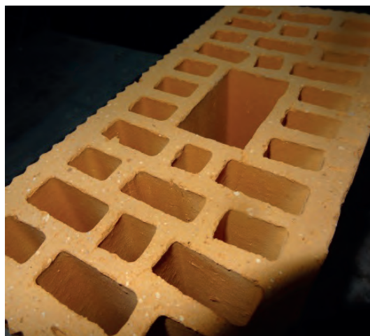
Рис. 3. Поверхность керамического кирпича после шлифования
