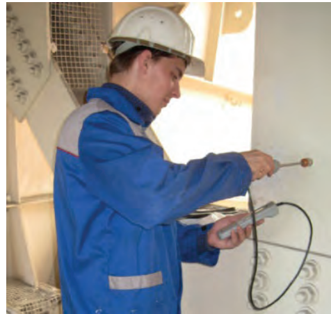
Рис. 11. Измерение контактным термометром ТК-5.01 П температуры штанги прибора (а) и элемента конструкции (б)
