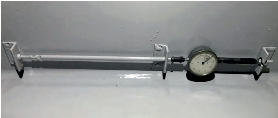
Рис. 3. Установленный механический тензометр со съемным деформометром
