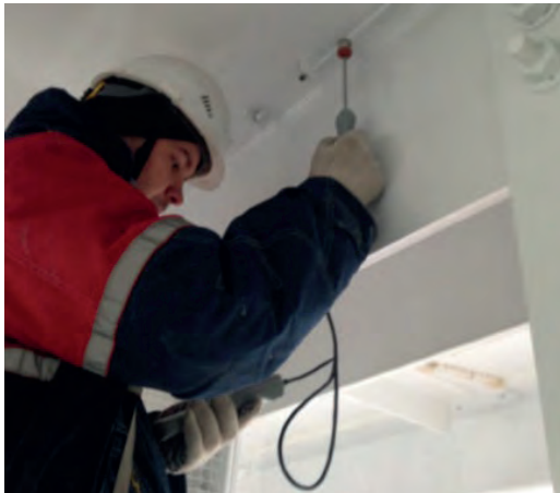
Рис. 11. Измерение контактным термометром ТК-5.01 П температуры штанги прибора (а) и элемента конструкции (б)
