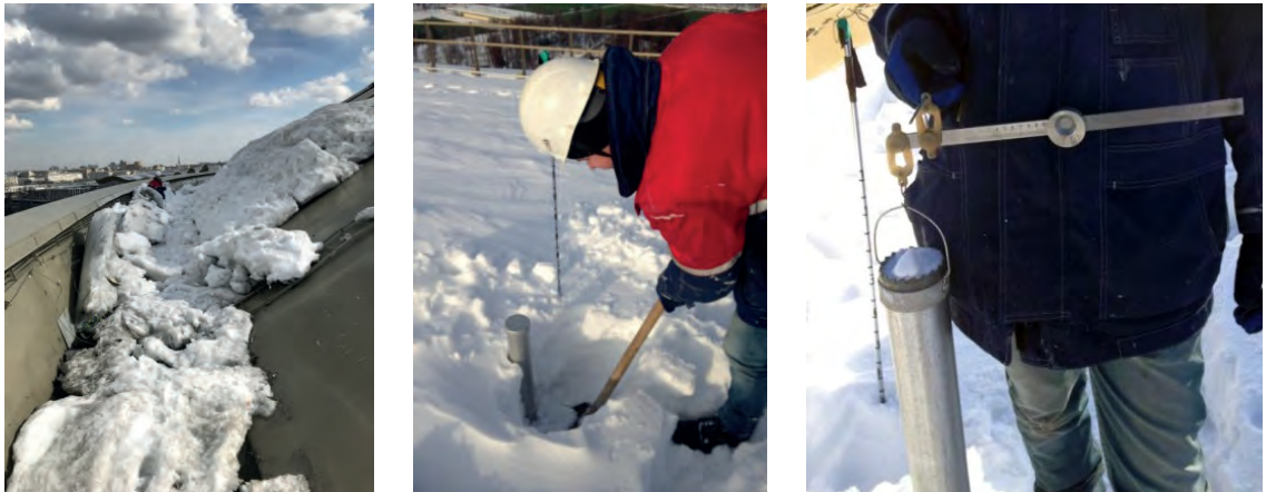
Рис. 13. Отложение снега на покрытии БСА и измерение снеговой нагрузки весовым снегомером ВС43
