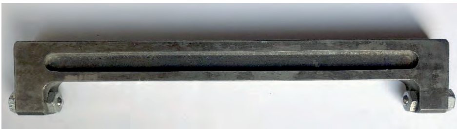
Рис. 3. Установленный механический тензометр со съемным деформометром
