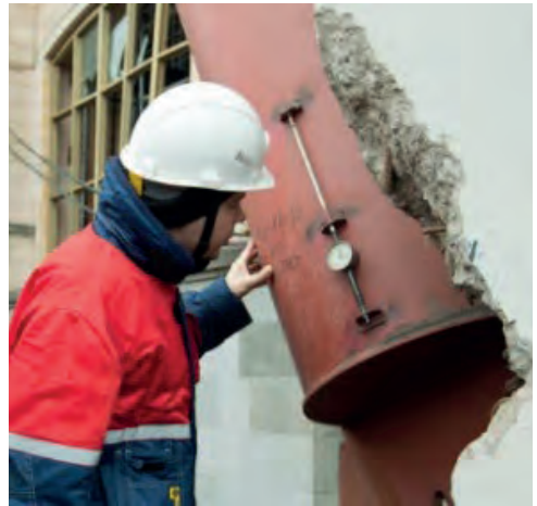
Рис. 6. Установка и снятие показаний с приборов на конструкции покрытия и временных связях при реконструкции БСА
