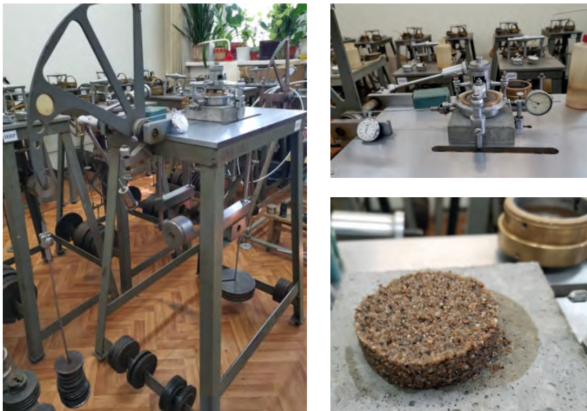
Рис. 3. Испытание на прочность контакта бетон – грунт: слева – общий вид прибора ПСГ-3М; справа сверху – образец грунта в кольце, установленный на бетонную плашку; справа снизу – образец грунта после проведения испытания
