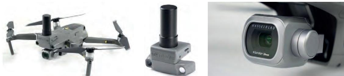
**Рис. 2.** Квадрокоптер Topodrone DJI Mavic 2 Pro со спутниковым приёмником и цифровой фотокамерой высокого разрешения
