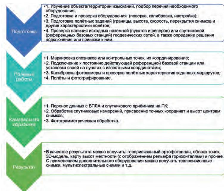
Рис. 1. Схема проведения аэрофото съёмки с применением БПЛА
