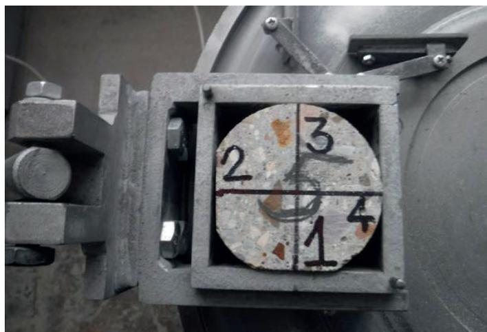
Рис. 6. Образец-кern в кассете круга истирания ЛКИ-3
