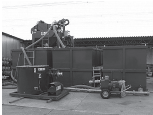
Рис. 1. Бентонитовые заводы, включающие смесители, насосы, центрифуги, объем для регенерации раствора (слева), хранилище бентонитового порошка, хранилище использованного шлама (справа) (с сайта фирмы DRILLTECH http://drilltech.ru/ )
