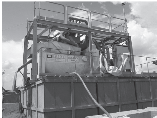
Рис. 1. Бентонитовые заводы, включающие смесители, насосы, центрифуги, объем для регенерации раствора (слева), хранилище бентонитового порошка, хранилище использованного шлама (справа) (с сайта фирмы DRILLTECH http://drilltech.ru/ )
