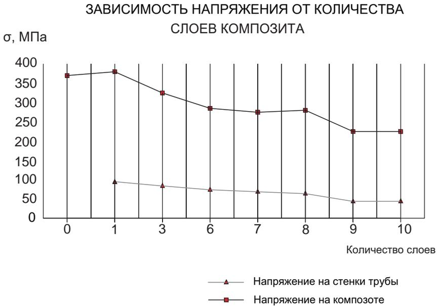
**Рис. 4.** График зависимости напряжений от количества слоев композитного материала
