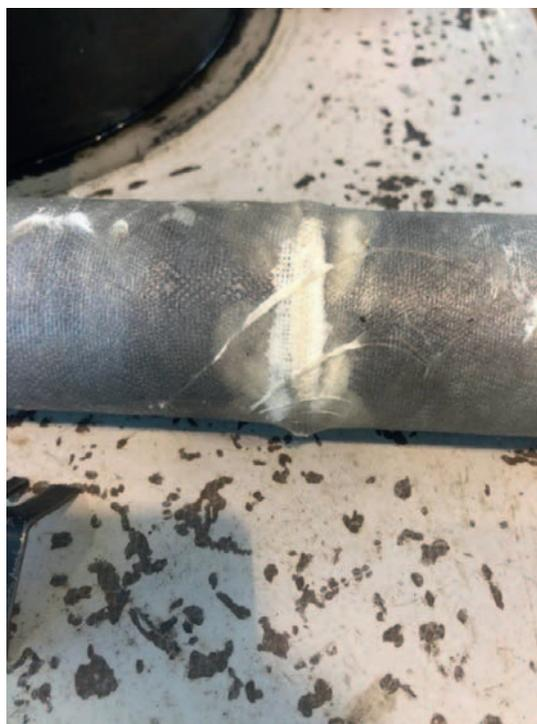
**Рис. 9.** Зона дефекта сварного шва после проведения эксперимента
