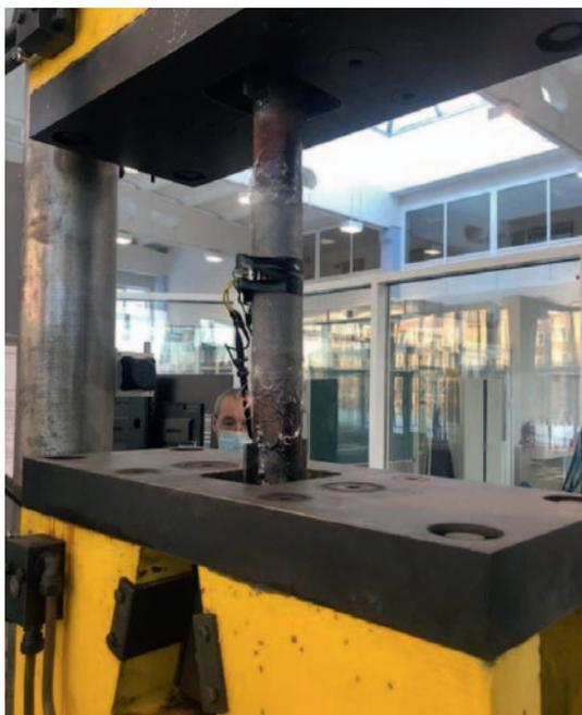
**Рис. 6.** Установка образца на разрывную машину для статических испытаний металлов Р-100
