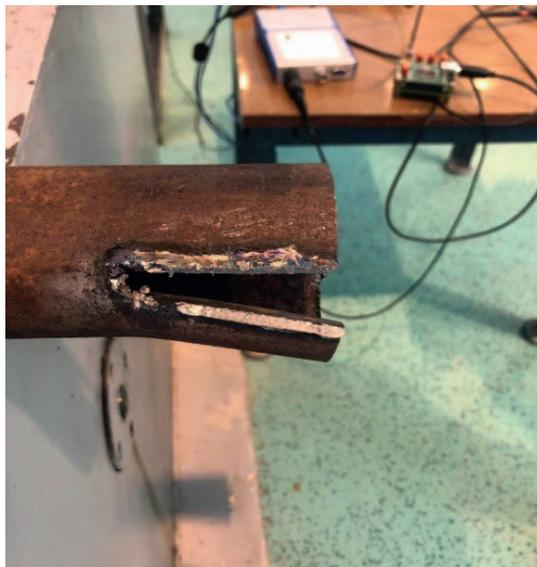
**Рис. 8.** Разрушение сварного шва оснастки
