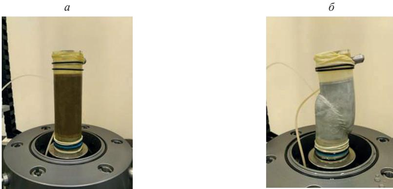
Рис. 3. Образец песчаного грунта до (а) и после (б) испытания
