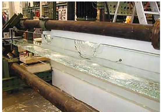
Рис. 9. Догрузка осевой нагрузкой поврежденной колонны [1]
