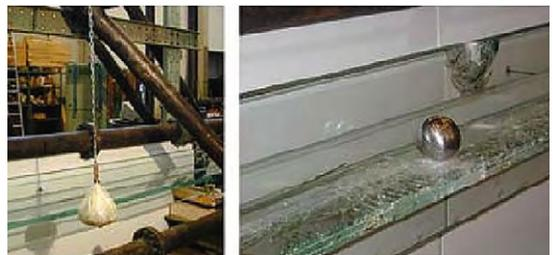
Механические воздействия на модель колонны при осевой нагрузке
