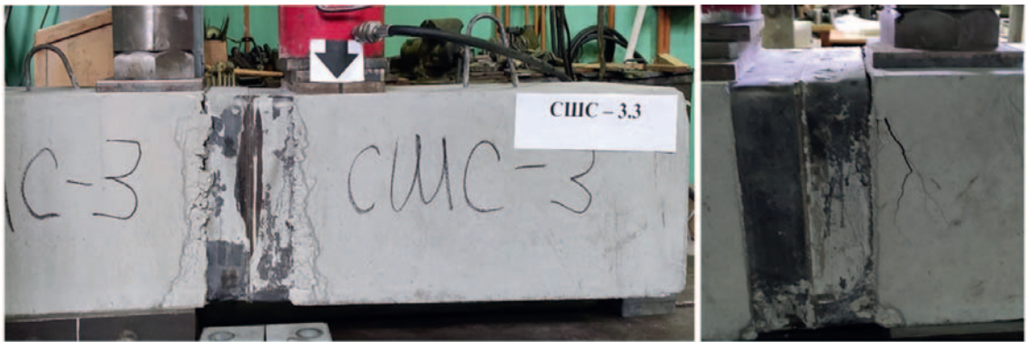
Рис. 6. Характерная схема разрушения опытных образцов серии СШС-3 при поперечном сдвиге Fig. 6. Characteristic destruction scheme of series 3 samples under the transverse shear
