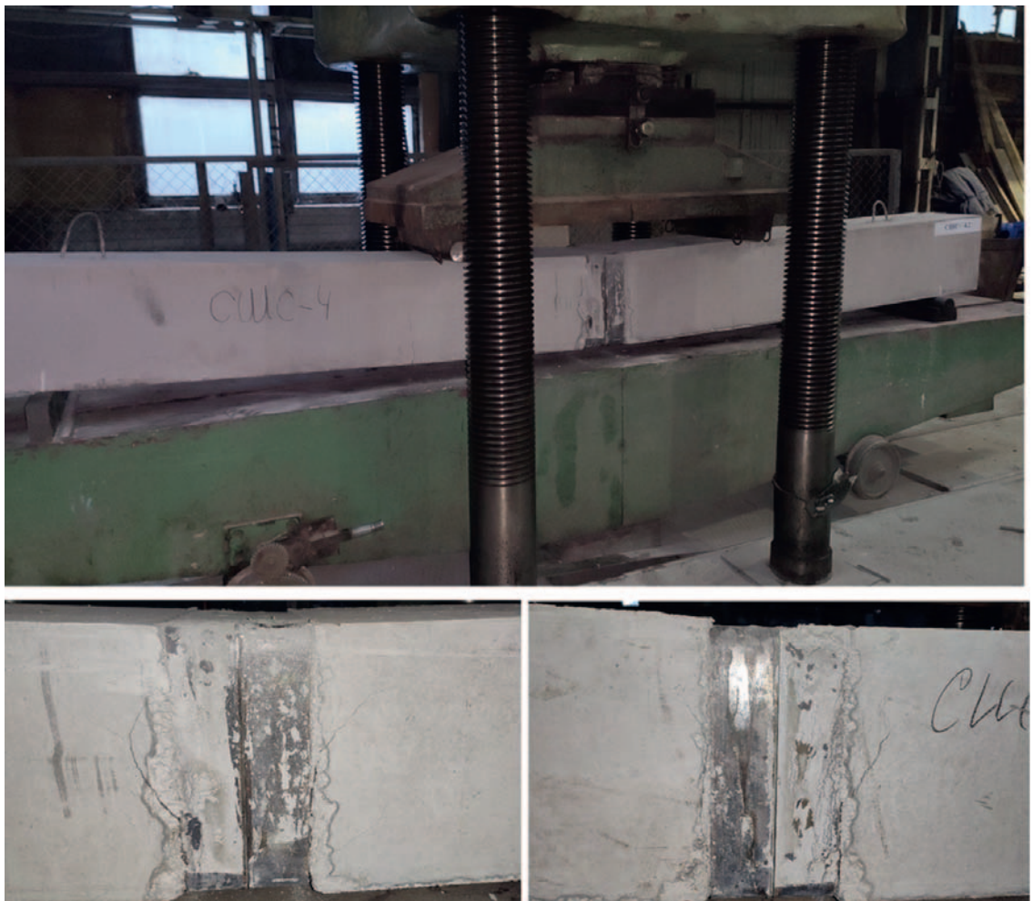
Рис. 7. Характерная схема разрушения опытных образцов серии СШС-4 при изгибе Fig. 7. Characteristic destruction scheme of series 4 samples under the bending
