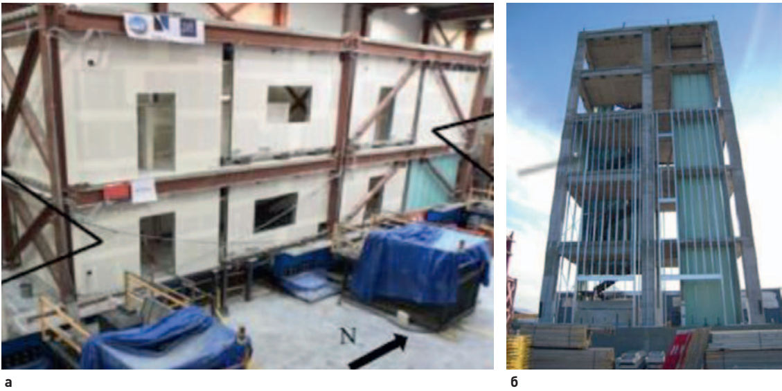
Рис. 9. Экспериментальные образцы моделей и фрагментов зданий с ненесущими конструкциями из ЛСТК, испытанных на сейсмоплатформах: а – двухэтажное здание со стальным каркасом, включающее перегородки и потолочные системы из ЛСТК [43]; б – пятиэтажное железобетонное здание, включающее перегородки и фасадные системы [45] Fig. 9. Experimental models and fragments of buildings with non-load-bearing LGSFS structures tested on shake table: a – e two-storey building having steel frame including LGSFS partition walls and ceiling systems [43]; b – five-storey reinforced concrete building including partition walls and facade systems [45]
