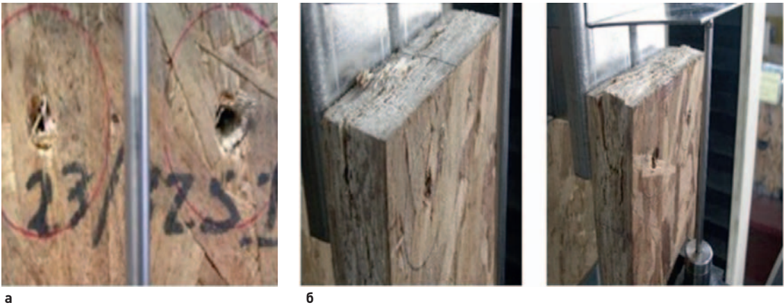
Рис. 8. Наблюдаемые виды отказов [42]: а – сквозное протягивание саморезов через зону соединения элементов; б – растрескивание панели обшивки по толщине Fig. 8. Observed failure modes [42]: a – protruding self-tapping screw through element joint area; b – cladding panel cracking over thickness
