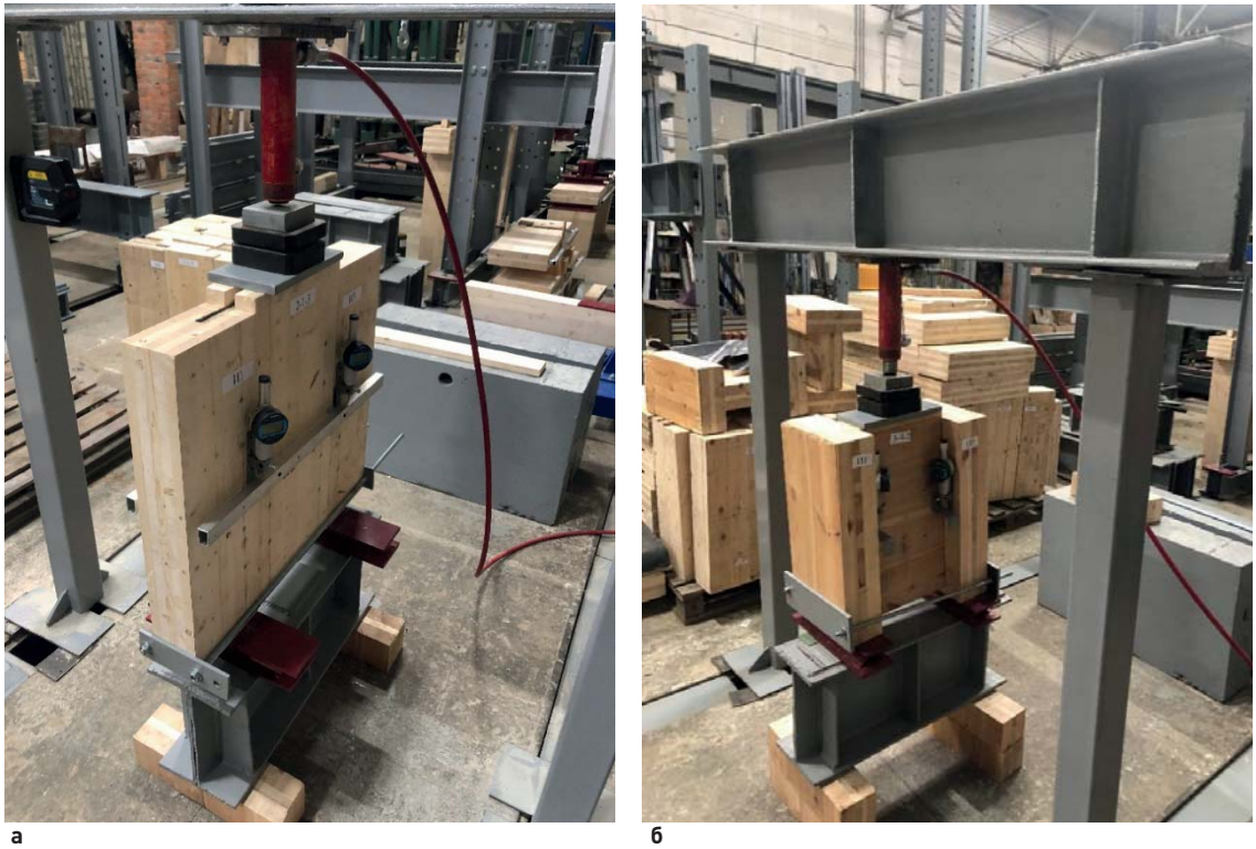
Рис. 5. Испытательный стенд для образцов узловых соединений типов «с прокладкой» (а) и «угловой» (б) Fig. 5. Test bench for gasket-sealed (a) and halved corner (b) joints
