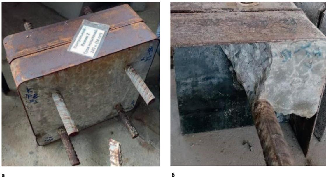
**Рис. 4.** Общие виды опытного образца до распиловки (а) и его фрагмента, образованного после распиловки (б)
