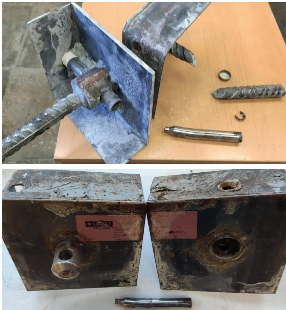
**Рис. 5.** Общий вид элементов штифтового соединения после испытаний на разрыв (в разобранном виде) и характерная схема его разрушения при действии осевой растягивающей нагрузки
