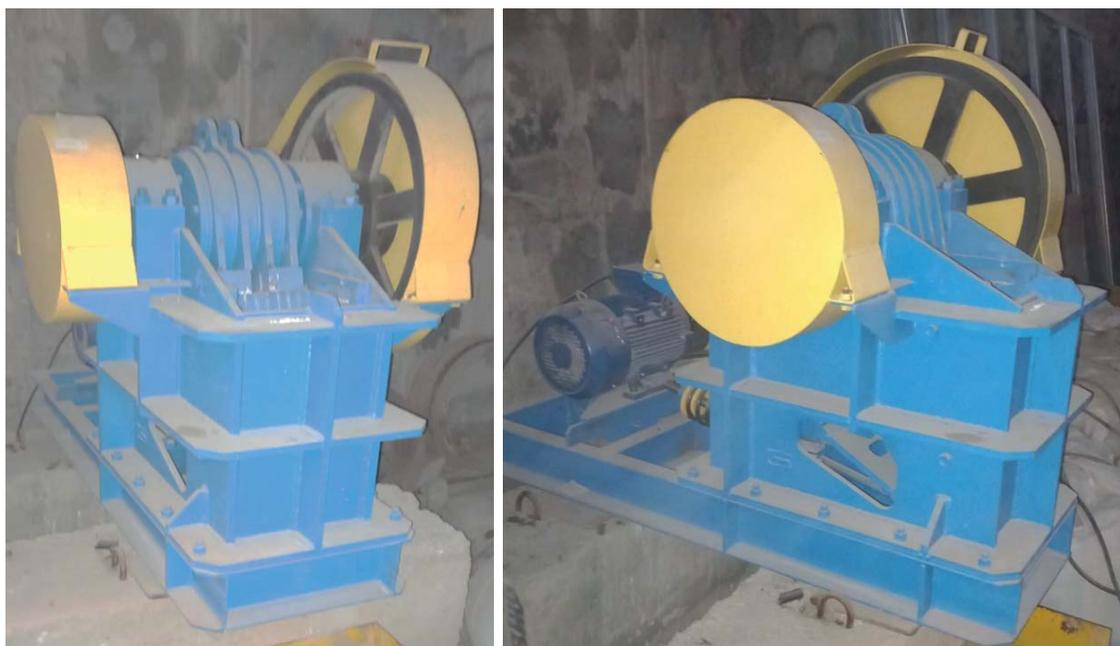
**Рис. 1.** Общий вид щековой дробилки ЩДС 180 × 250
