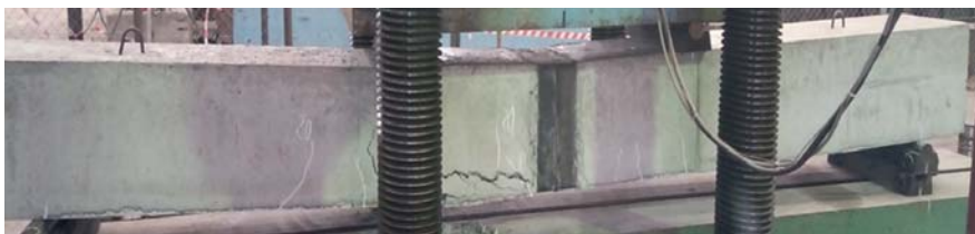
Рис. 5. Характерная схема разрушения опытных образцов серии СШС-4.4-3 при поперечном сдвиге Fig. 5. Characteristic destruction scheme of series 4.4-3 samples under the transverse shear
