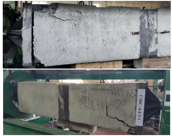
Рис. 4. Общие виды испытаний образцов серии СШС-4.4-2 при растяжении Fig. 4. General views of samples under the tensile
