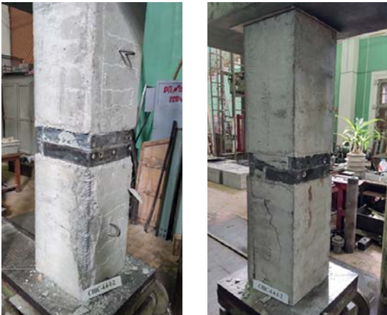
Рис. 3. Характерная схема разрушения опытных образцов серии СШС-4.4-1 при сжатии Fig. 3. Characteristic destruction scheme of series 4.4-1 samples under the compression
