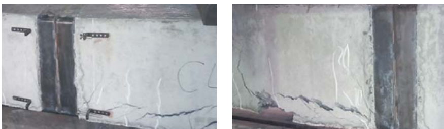
Рис. 6. Характерная схема разрушения опытных образцов серии СШС-4.4-4 при изгибе Fig. 6. Characteristic destruction scheme of series 4.4-4 samples under the bending
