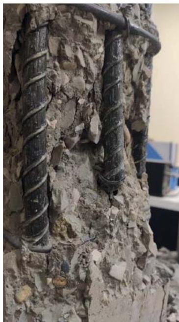
**Рис. 3.** Типовая картина разрушения опытных образцов
