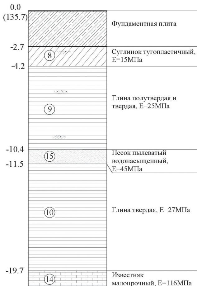
Рис. 2. Характерный разрез грунтового основания под подошвой фундаментной плиты Fig. 2. Typical section of bearing soil under the foundation slab
