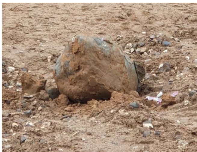
Рис. 5. Фото валуна диаметром ~0,3 м, извлеченного из-под подошвы сваи Fig. 5. Photo of a boulder measuring ~0.3 m in diameter extracted from under a pile
