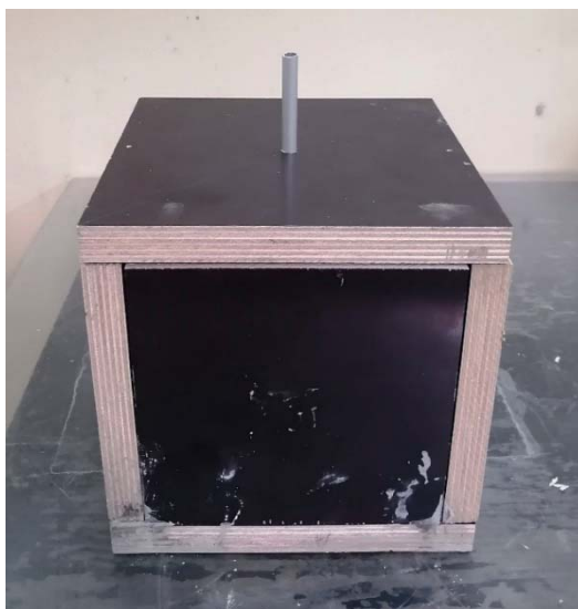
Рис. 1. Вид деревянной формы для заливки цементной смеси Fig. 1. View of a wooden mold for pouring the cement mix
