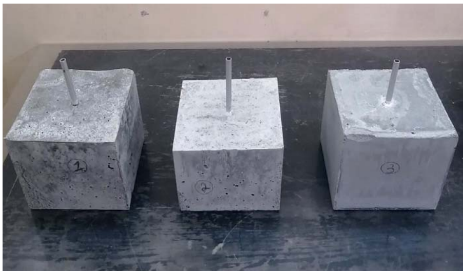
Рис. 4. Образцы бетона, полученного в процессе эксперимента Fig. 4. Experimental concrete samples
