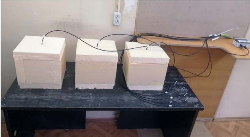
Рис. 2. Вид образцов цементной смеси, упакованных в теплоизоляционные ящики и подключенных к термокосе для измерения температуры
