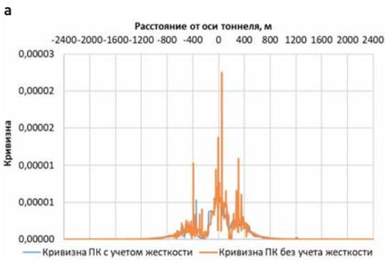
**Рис. 2.** Деформации земной поверхности при моделировании с учетом жесткости трубопровода и без учета: *a* – вертикальные перемещения; *б* – величина кривизны трубопровода
