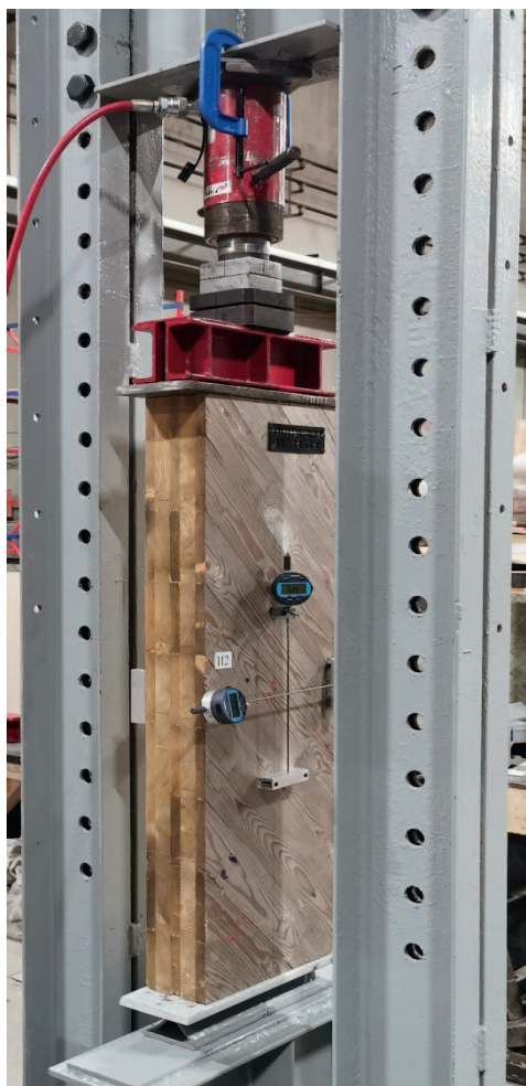
Рис. 4. Общий вид испытательного стенда для определения модуля сдвига в плоскости плиты
