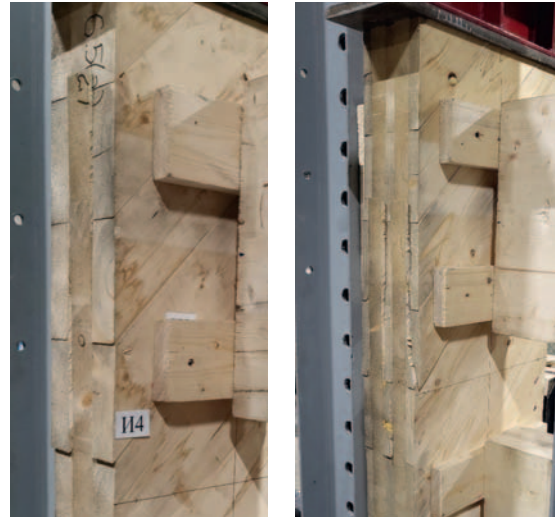
Рис. 5. Характер разрушения трехслойных (слева) и пятислойных (справа) плит ДПК/CLT при сдвиге в плоскости плиты
