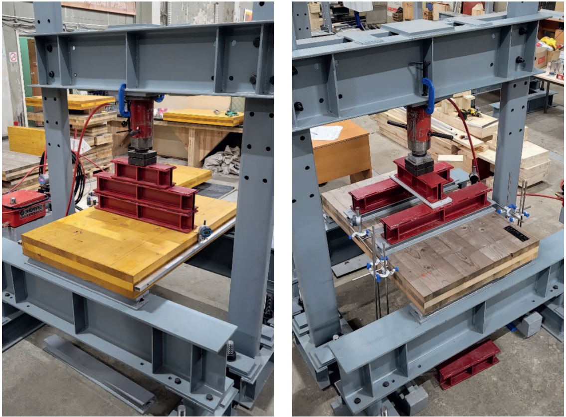
Рис. 3. Общий вид испытательного стенда. Испытания по определению условного модуля упругости (слева) и предела прочности на сдвиг по поперечному сечению плиты (справа)
