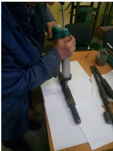
Рис. 4. Резьбо-клеевые соединения Fig. 4. Threaded joint locked with an adhesive
