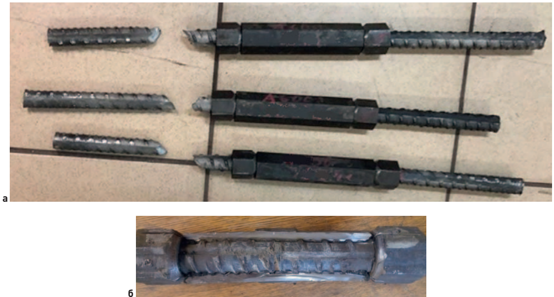
Рис. 9. а – разрушенные образцы; б – разрез соединительной муфты испытанного образца Fig. 9. а – destroyed specimens; б – section of the coupler in the test specimen
