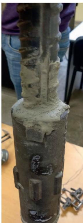
Рис. 6. Образец винтовых муфтовых соединений арматуры с клеевым составом на цементной основе Fig. 6. Example of screw couplings in rebars locked with a cement-based adhesive compound
