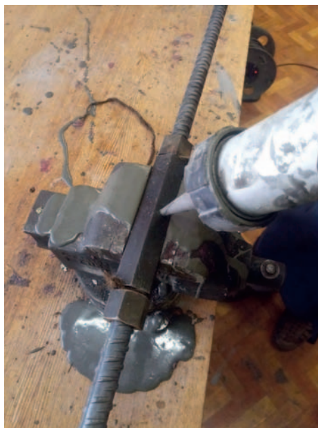
Рис. 4. Резьбо-клеевые соединения Fig. 4. Threaded joint locked with an adhesive
