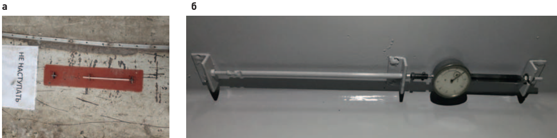
Рис. 9. Механический тензометр а – без съемного деформометра; б – со съемным деформометром Fig. 9. Mechanical strain gauge a – no removable strainmeter; б – with removable strainmeter
