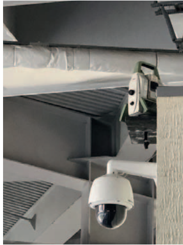
Рис. 18. Тахеометр на кронштейне автоматизированной системы Fig. 18. Tacheometer mounted on a bearing element of an automated system
