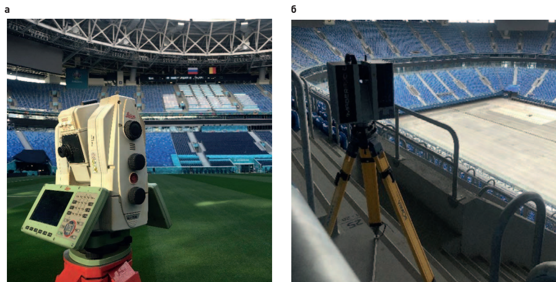
Рис. 15. Съемка и лазерное сканирование конструкций покрытия: а – съемка с помощью тахеометра; б – проведение лазерного сканирования Fig. 15. Shooting and laser scanning of shell structures: а – shooting using a tacheometer; б – laser scanning
