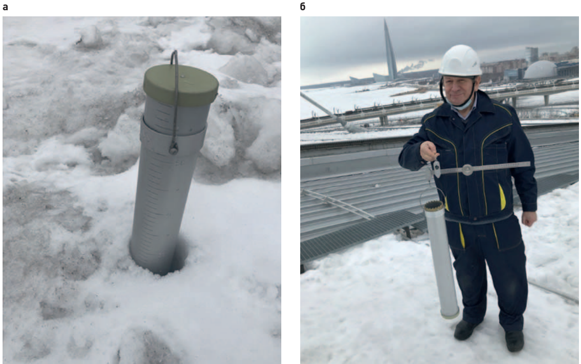
Рис. 12. Измерение снеговой нагрузки на покрытие весовым снегомером а – весовой снегомер; б – определение интенсивности снеговой нагрузки
