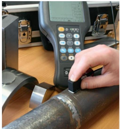
**Рис. 7.** Ультразвуковой контроль сварного соединения
