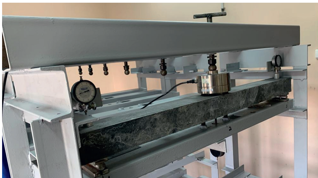
Рис. 4. Установленный образец балки для проведения длительных испытаний по определению релаксации напряжений в бетоне при изгибе Fig. 4. Installed beam sample for the long-term tests of concrete for bending stress relaxation
