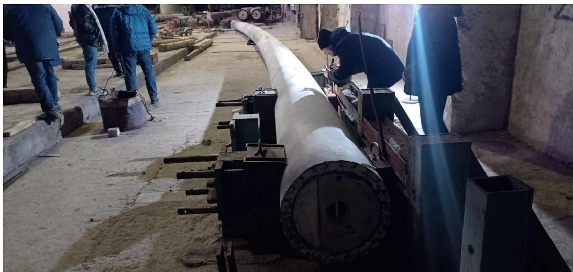
**Рис. 14.** Стойка в деформированном состоянии перед разрушением
