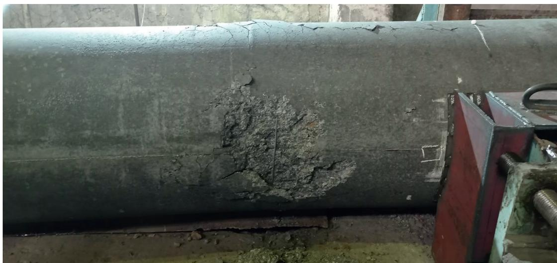
**Рис. 13.** Фрагмент стойки в сжатой зоне разрушения бетона
