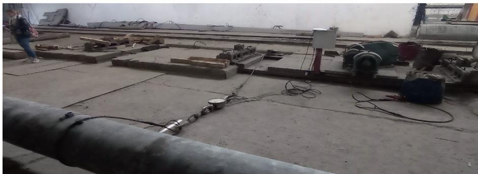
**Рис. 10.** Фрагмент стенда в месте приложения нагрузки
