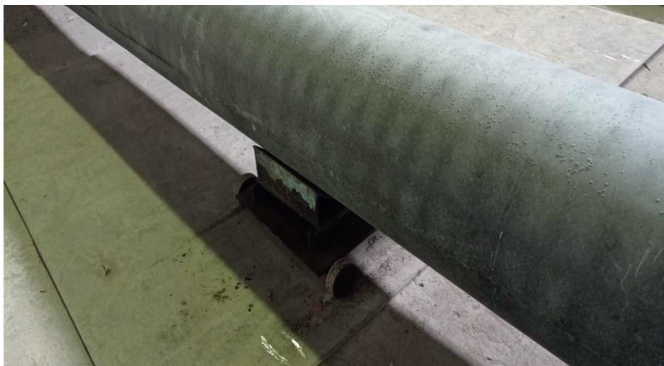
**Рис. 9.** Фрагменты элементов стенда: подвижная опора
