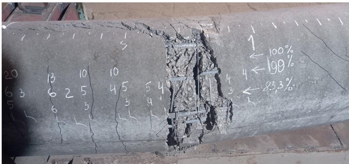
**Рис. 12.** Схема излома стойки СКЗ со стороны растянутой зоны
