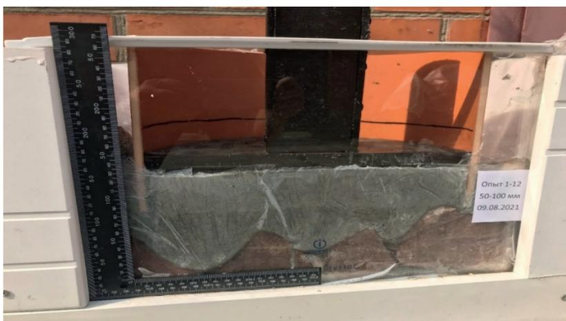
**Рис. 3.** Контакт БКМ с грунтом с размером обломков 50–100 мм
