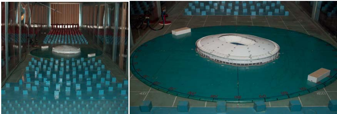
Рис. 23. Испытание модели в аэродинамической трубе для определения снеговых и ветровых нагрузок Fig. 23. Wind tunnel testing of the model to determine snow and wind loads
