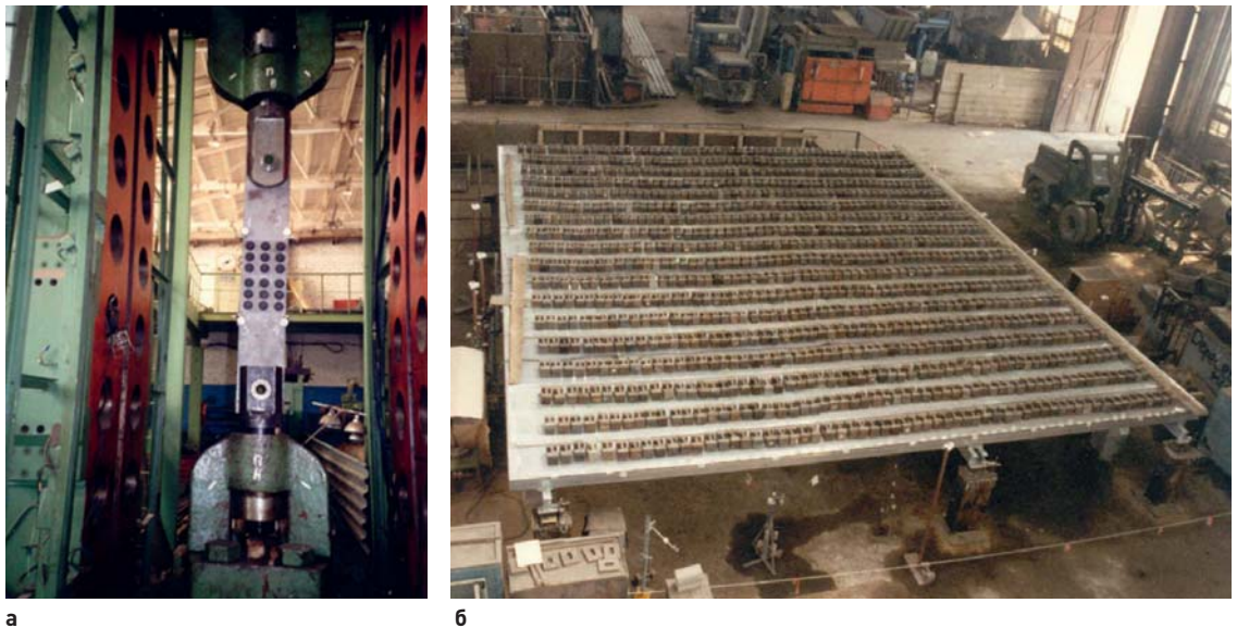
Рис. 7. Испытания узлов и частей БСА: а – узел фрикционного соединения монтажных элементов; б – испытания светопрозрачной поликарбонатной панели
