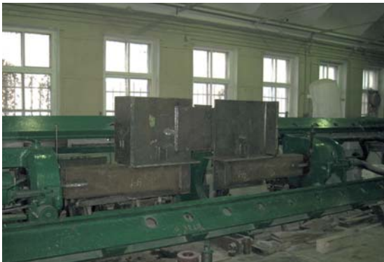
Рис. 25. Испытания реального узла соединения консольной части покрытия с существующей частью покрытия БСА Fig. 25. Testing the real joint of the cantilever part of the roof with the existing part of the GSA roof
