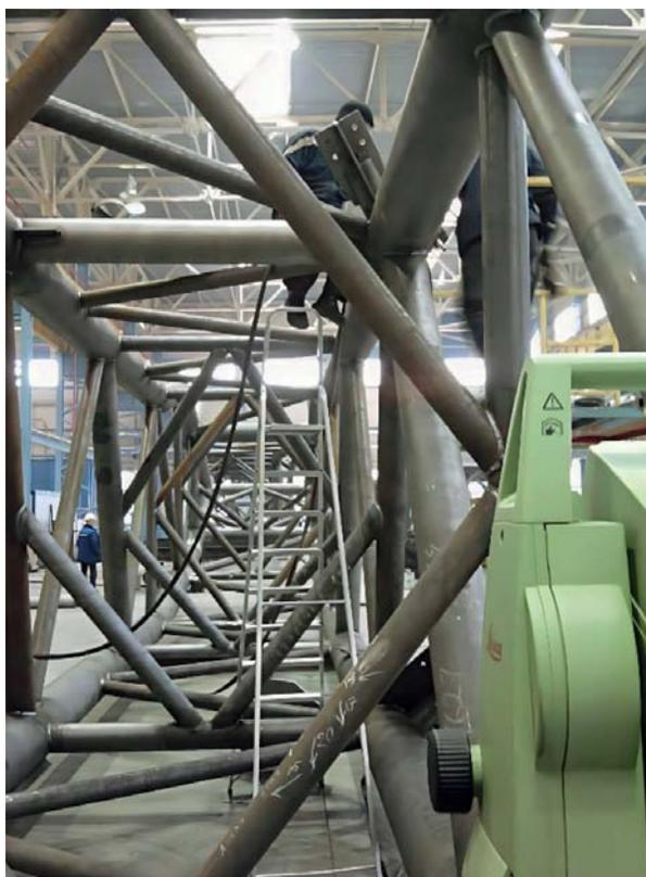
**Рис. 14.** Контроль изготовления элементов пирамиды для церемонии открытия и закрытия Универсиады на ЗМК в г. Нижнекамске
