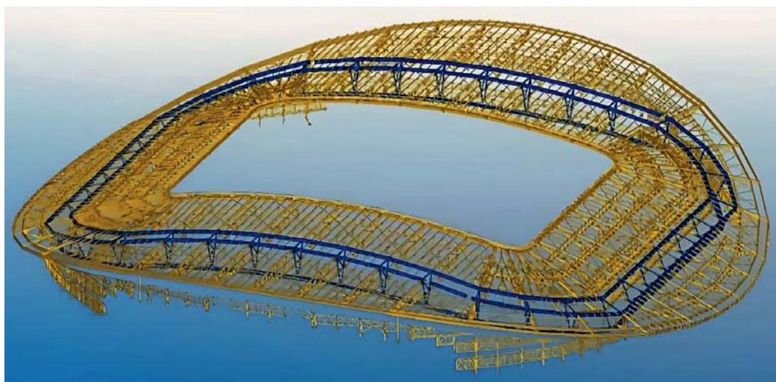
**Рис. 15.** Контроль геометрии главного ригеля
