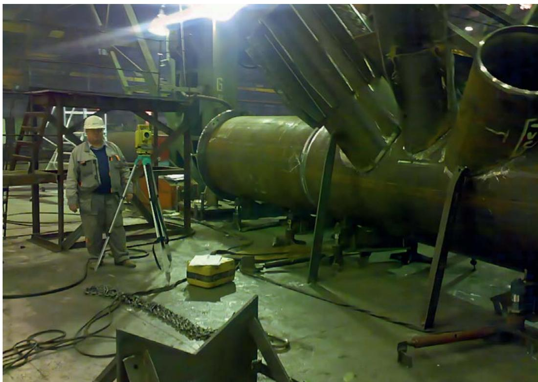
**Рис. 12.** Контроль изготовления сборных элементов главного ригеля на ЗМК в г. Белгороде
