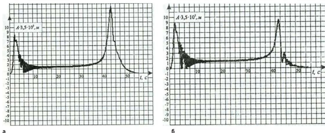
**Рис. 3.** Перемещения  $y = A \times 10^3$ (м): а – линейная система; б – система с кубической характеристикой
