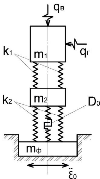
**Рис. 1.** Расчетная схема системы с двумя степенями свободы:  $k_i$  – жесткости связей;  $D_0$  – демпфер вязкого трения
