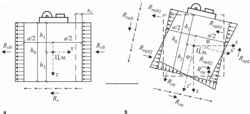
**Рис. 2.** Реакции в системе «фундамент-грунт» при горизонтальных (а) и вращательных (б) колебаниях
