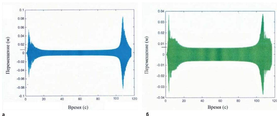
**Рис. 4.** Перемещения, (м), в системе с одной степенью свободы: а – линейная система; б – с демпфером вязкого трения
