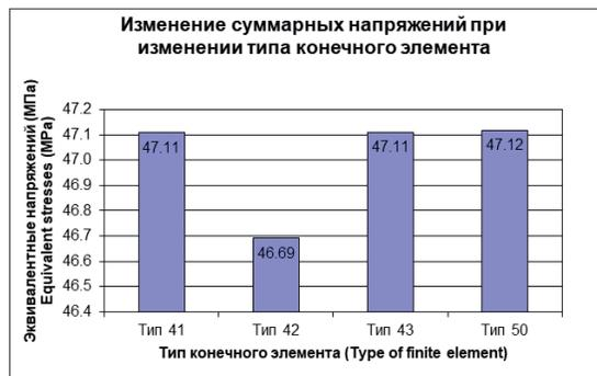
**Рис. 3.** Изменение эквивалентных напряжений при изменении типа КЭ
