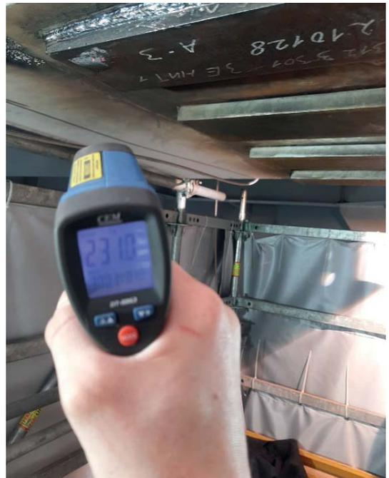
Рис. 7. Проверка температуры поверхности элементов пирометром
