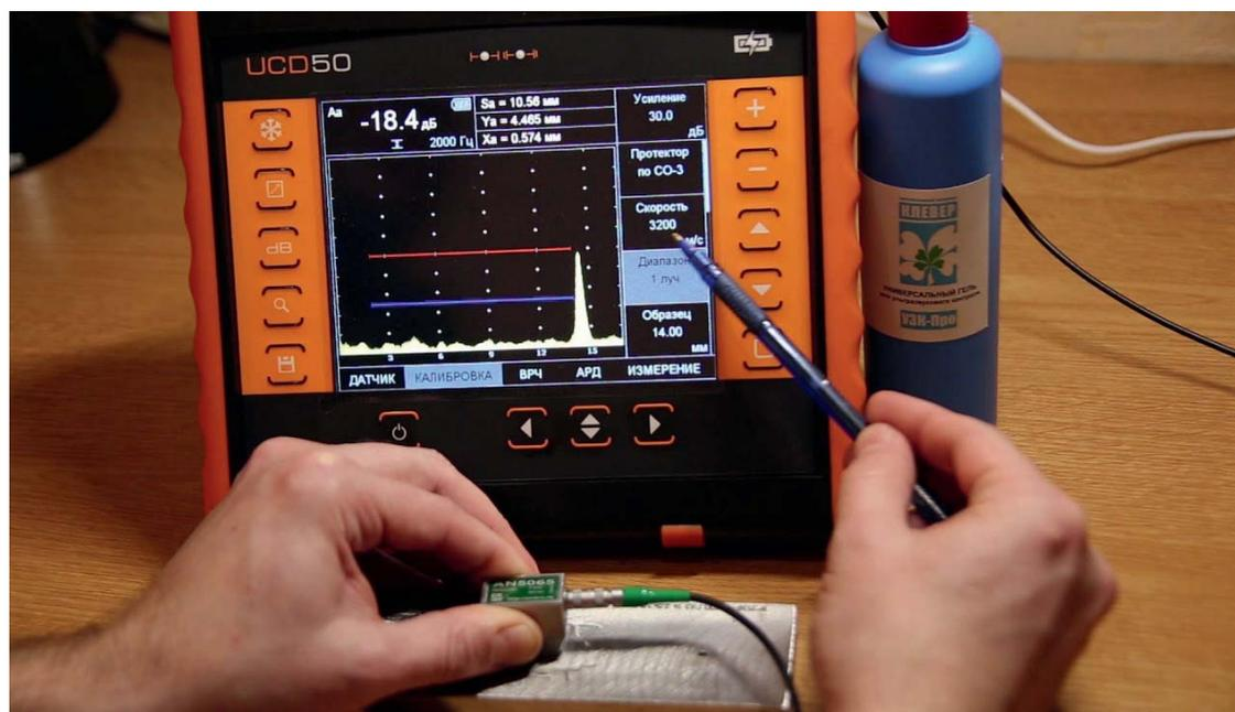
Рис. 10. Настройка дефектоскопа перед проведением ультразвукового контроля
