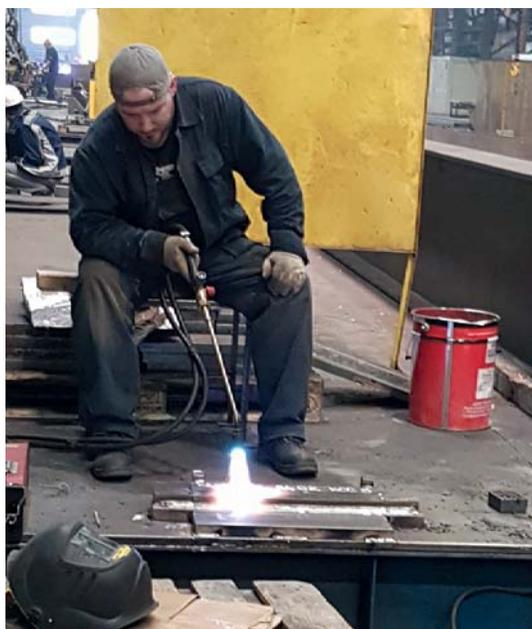
**Рис. 4.** Прогрев элементов контрольного сварного соединения
