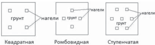
Рис. 2. Конфигурация нагелей при эксперименте Fig. 2. Dowel configuration in the experiment
