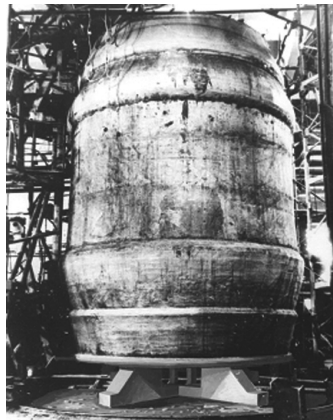
Рис. 8. Модель корпуса реактора из ТАЦ в \frac{1}{3} натуральной величины после изготовления
