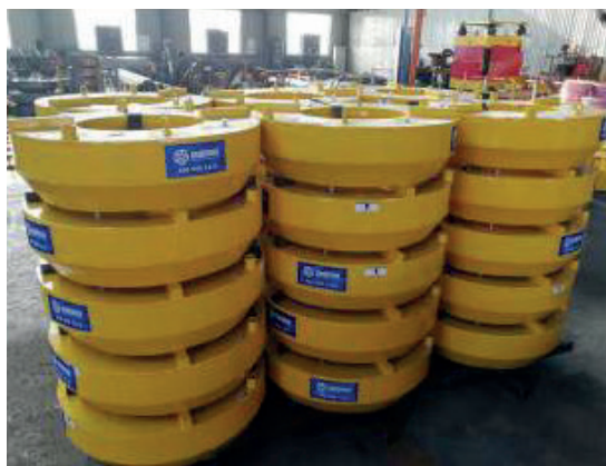
Рис. 5. Готовые модули (двунаправленные испытания свай погружными домкратами) для установки в сваи по методике Bi-directional test (Китай)
