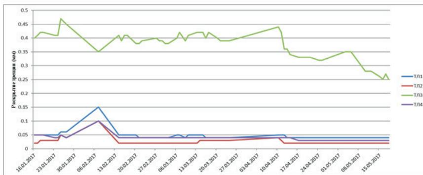
Рис. 24. Раскрытие трещин в лицевом слое левой стены с января по май 2017 г.
