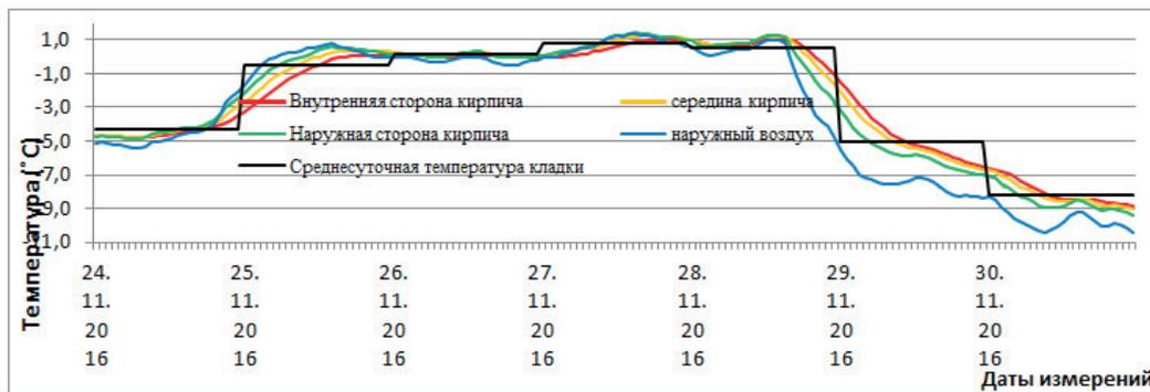
Рис. 16д. Графики изменения температуры наружного воздуха и лицевого слоя в ноябре 2016 г.
