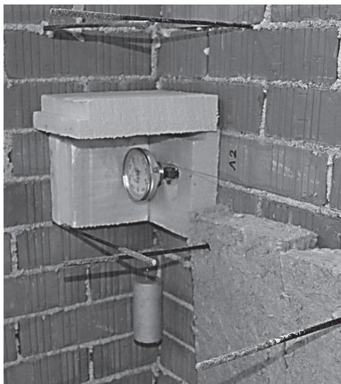
**Рис. 11.** Прогибомер для измерения горизонтальных перемещений кладки лицевого слоя с его внутренней стороны
