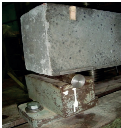
Рис. 7. Инвентарная шарнирно-подвижная опора
