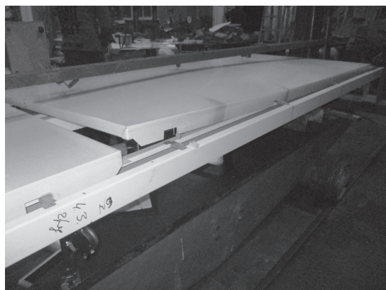
Рис. 6. Деформирование направляющей и панели в процессе испытаний
