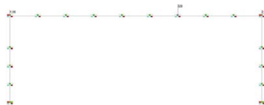
Рис. 8. Расчетная схема портала с указанием предельной нагрузки, местных осей элементов и граничных условий
