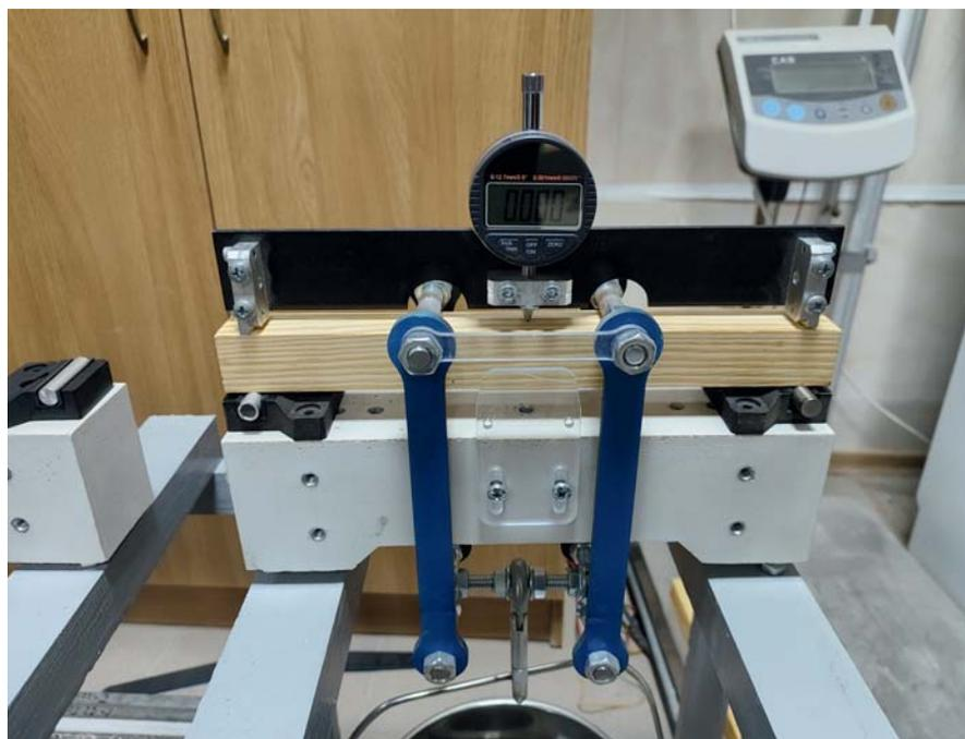
Рис. 4. Испытание деревянных образцов на четырехточечный изгиб
