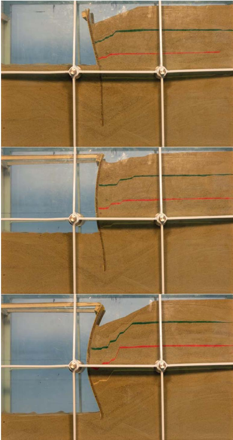
**Рис. 5.** Деформированные схемы, полученные для различных схем работы подпорной стенки
