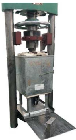
**Рис. 2.** Общий вид установки для испытаний бетонов при кратковременном нагреве
