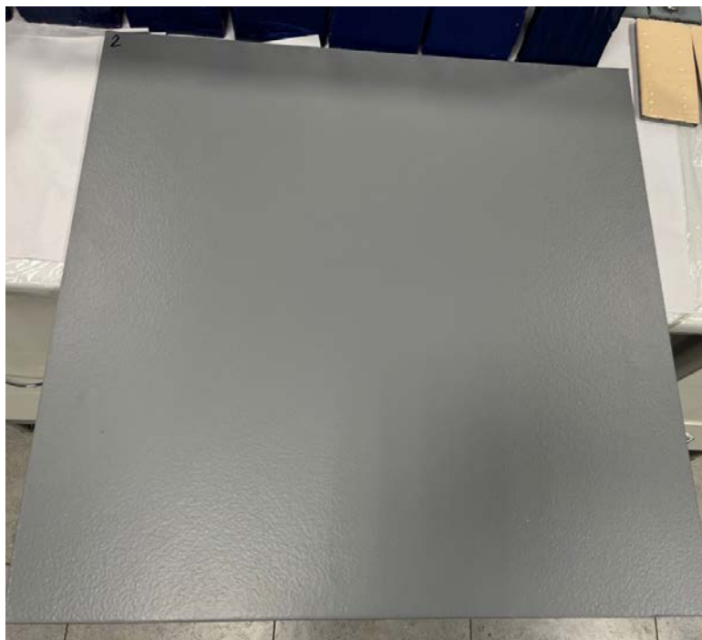
Рис. 2. Состояние покрытия после 45 циклов старения Fig. 2. The coating after 45 aging cycles
