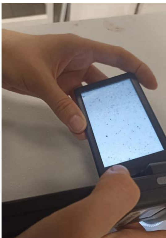
Рис. 5. Оценка состояния поверхности покрытия после 224 циклов старения Fig. 5. Assessment of the coating surface after 224 aging cycles
