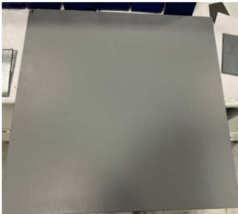
Рис. 3. Состояние системы покрытия после 134 циклов старения Fig. 3. The coating system after 134 aging cycles
