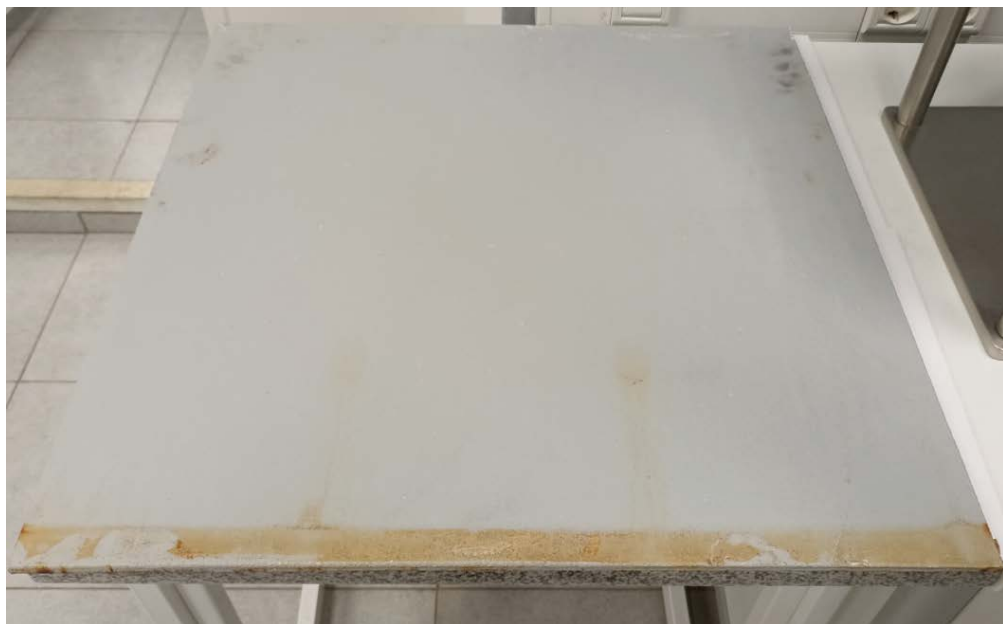
Рис. 4. Состояние системы покрытия после 224 циклов старения Fig. 4. The coating system after 224 aging cycles
