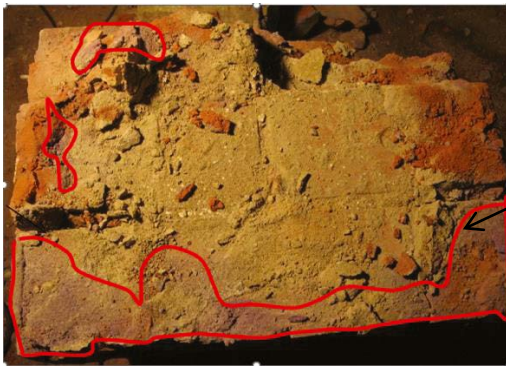
Рис. 7. Проникание метилметакрилата в кладку с трещинами, образовавшимися после первого этапа испытаний. Пропиталась кладка в основном только в нижней части образца Fig. 7. Penetration of methyl methacrylate into a masonry structure with cracks formed after the first stage of testing. The masonry was mainly impregnated only in the lower part of the specimen
