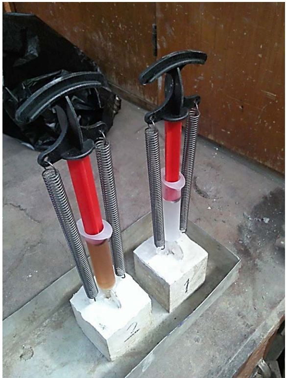
Рис. 4. Пробная инъекция метилметакрилата без давления в растворные кубики Fig. 4. Test injection of methyl methacrylate without pressure into mortar cubes
