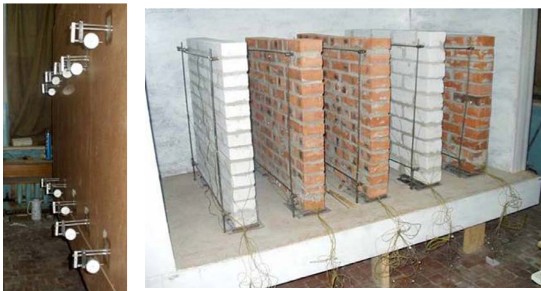
Рис. 2. Вид лабораторных образцов для исследования КЛТД, индикаторы часового типа Fig. 2. Type of laboratory samples for CLTE research, dial indicators
